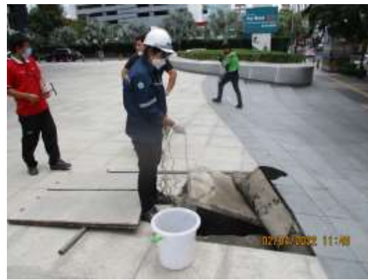
รูปที่ 4-32 การเก็บตัวอย่างคุณภาพน้ำทิ้ง บริเวณน้ำทิ้งก่อนระบายออกนอกโครงการ (บ่อพักน้ำสุดท้ายพร้อมตะแกรงดักขยะ) เก็บตัวอย่างในวันที่ 2 เมษายน 2565
