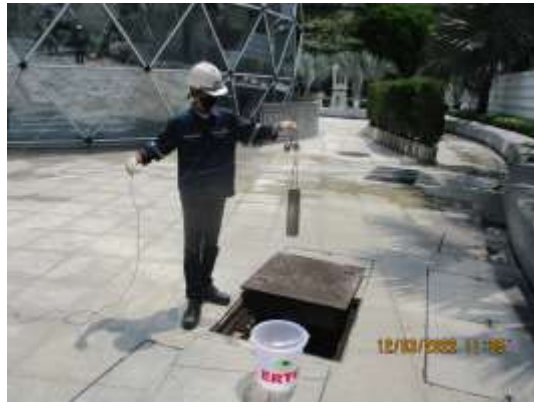
รูปที่ 4-25 การเก็บตัวอย่างคุณภาพน้ำทิ้ง บริเวณน้ำทิ้งหลังการบำบัด (บ่อสูบน้ำใส) เก็บตัวอย่างในวันที่ 12 มีนาคม 2565
