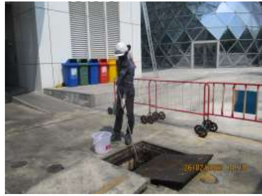
รูปที่ 4-18 การเก็บตัวอย่างคุณภาพน้ำทิ้ง บริเวณน้ำทิ้งก่อนการบำบัด (ถังแยกตะกอน) เก็บตัวอย่างในวันที่ 26 กุมภาพันธ์ 2565
