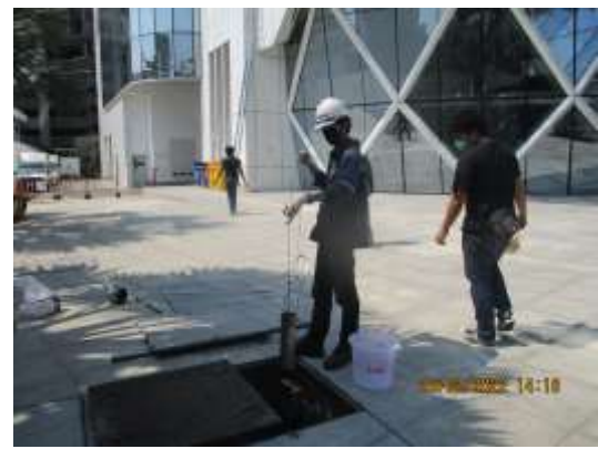
รูปที่ 4-24 การเก็บตัวอย่างคุณภาพน้ำทิ้ง บริเวณน้ำทิ้งหลังการบำบัด (บ่อสูบน้ำใส) เก็บตัวอย่างในวันที่ 26 กุมภาพันธ์ 2565
