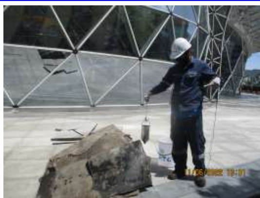
รูปที่ 4-34 การเก็บตัวอย่างคุณภาพน้ำทิ้ง บริเวณน้ำทิ้งก่อนระบายออกนอกโครงการ (บ่อพักน้ำสุดท้ายพร้อมตะแกรงดักขยะ) เก็บตัวอย่างในวันที่ 11 มิถุนายน 2565
