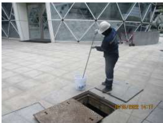
รูปที่ 4-27 การเก็บตัวอย่างคุณภาพน้ำทิ้ง บริเวณน้ำทิ้งหลังการบำบัด (บ่อสูบน้ำใส) เก็บตัวอย่างในวันที่ 14 พฤษภาคม 2565
