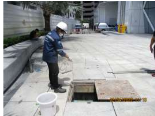
รูปที่ 4-26 การเก็บตัวอย่างคุณภาพน้ำทิ้ง บริเวณน้ำทิ้งหลังการบำบัด (บ่อสูบน้ำใส) เก็บตัวอย่างในวันที่ 2 เมษายน 2565
