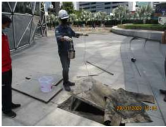
รูปที่ 4-29 การเก็บตัวอย่างคุณภาพน้ำทิ้ง บริเวณน้ำทิ้งก่อนระบายออกนอกโครงการ (บ่อพักน้ำสุดท้ายพร้อมตะแกรงดักขยะ) เก็บตัวอย่างในวันที่ 29 มกราคม 2565
