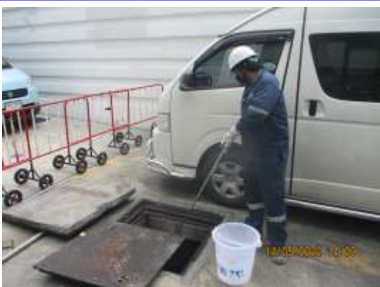
รูปที่ 4-21 การเก็บตัวอย่างคุณภาพน้ำทิ้ง บริเวณน้ำทิ้งก่อนการบำบัด (ถังแยกตะกอน) เก็บตัวอย่างในวันที่ 14 พฤษภาคม 2565
