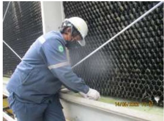
รูปที่ 4-36 การเก็บตัวอย่างคุณภาพน้ำจากระบบหอผึ่งเย็น บริเวณอ่างรองรับน้ำ เก็บตัวอย่างในวันที่ 14 พฤษภาคม 2565
