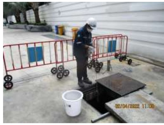
รูปที่ 4-20 การเก็บตัวอย่างคุณภาพน้ำทิ้ง บริเวณน้ำทิ้งก่อนการบำบัด (ถังแยกตะกอน) เก็บตัวอย่างในวันที่ 2 เมษายน 2565
