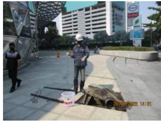
รูปที่ 4-30 การเก็บตัวอย่างคุณภาพน้ำทิ้ง บริเวณน้ำทิ้งก่อนระบายออกนอกโครงการ (บ่อพักน้ำสุดท้ายพร้อมตะแกรงดักขยะ) เก็บตัวอย่างในวันที่ 26 กุมภาพันธ์ 2565
