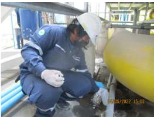
รูปที่ 4-37 การเก็บตัวอย่างคุณภาพน้ำจากระบบหอผึ่งเย็น บริเวณท่อน้ำทิ้งจากหอผึ่งเย็นแต่ละเครื่อง เก็บตัวอย่างในวันที่ 14 พฤษภาคม 2565
