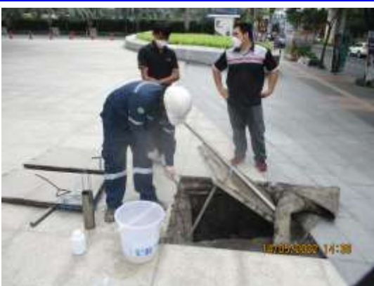
รูปที่ 4-33 การเก็บตัวอย่างคุณภาพน้ำทิ้ง บริเวณน้ำทิ้งก่อนระบายออกนอกโครงการ (บ่อพักน้ำสุดท้ายพร้อมตะแกรงดักขยะ) เก็บตัวอย่างในวันที่ 14 พฤษภาคม 2565
