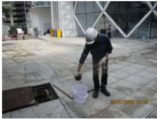
รูปที่ 4-23 การเก็บตัวอย่างคุณภาพน้ำทิ้ง บริเวณน้ำทิ้งหลังการบำบัด (บ่อสูบน้ำใส) เก็บตัวอย่างในวันที่ 29 มกราคม 2565
