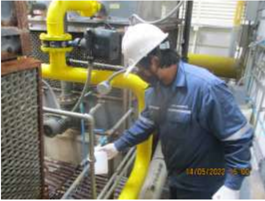
รูปที่ 4-35 การเก็บตัวอย่างคุณภาพน้ำจากระบบหอผึ่งเย็น บริเวณจุดที่น้ำไหลเข้ามาเติมในระบบ เก็บตัวอย่างในวันที่ 14 พฤษภาคม 2565
